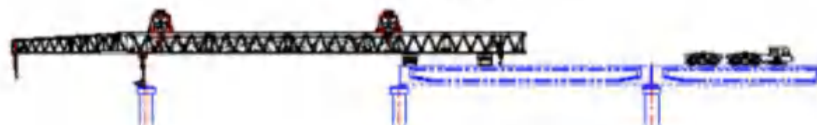
(4) 1#、2#吊重行车送梁
