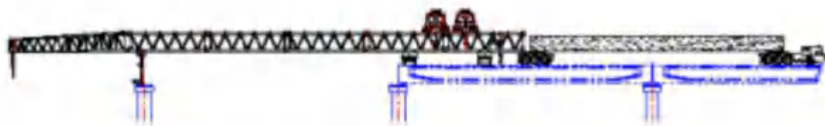
(1) 运梁车运梁至架桥机尾部
