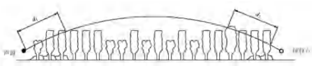
图5.4-5 通过树和灌木时噪声衰减示意图
