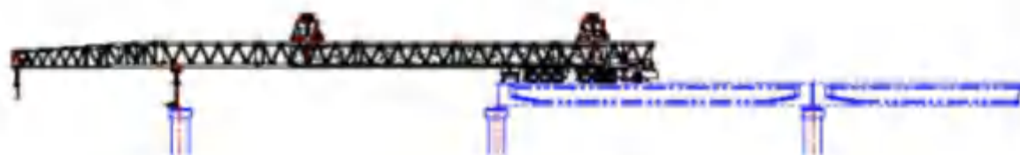
(3) 2#吊重行车起吊梁
