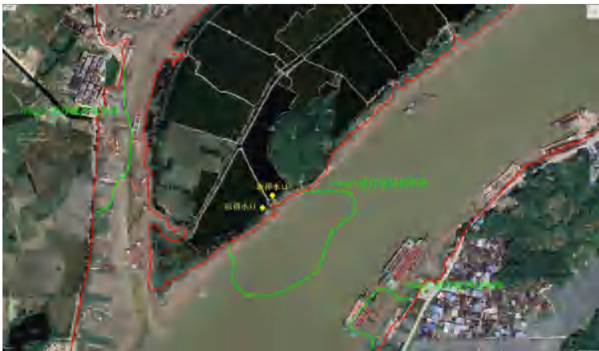
图 5.6-20 本项目悬浮泥沙包络线与周边围塘养殖取排水口的位置关系
