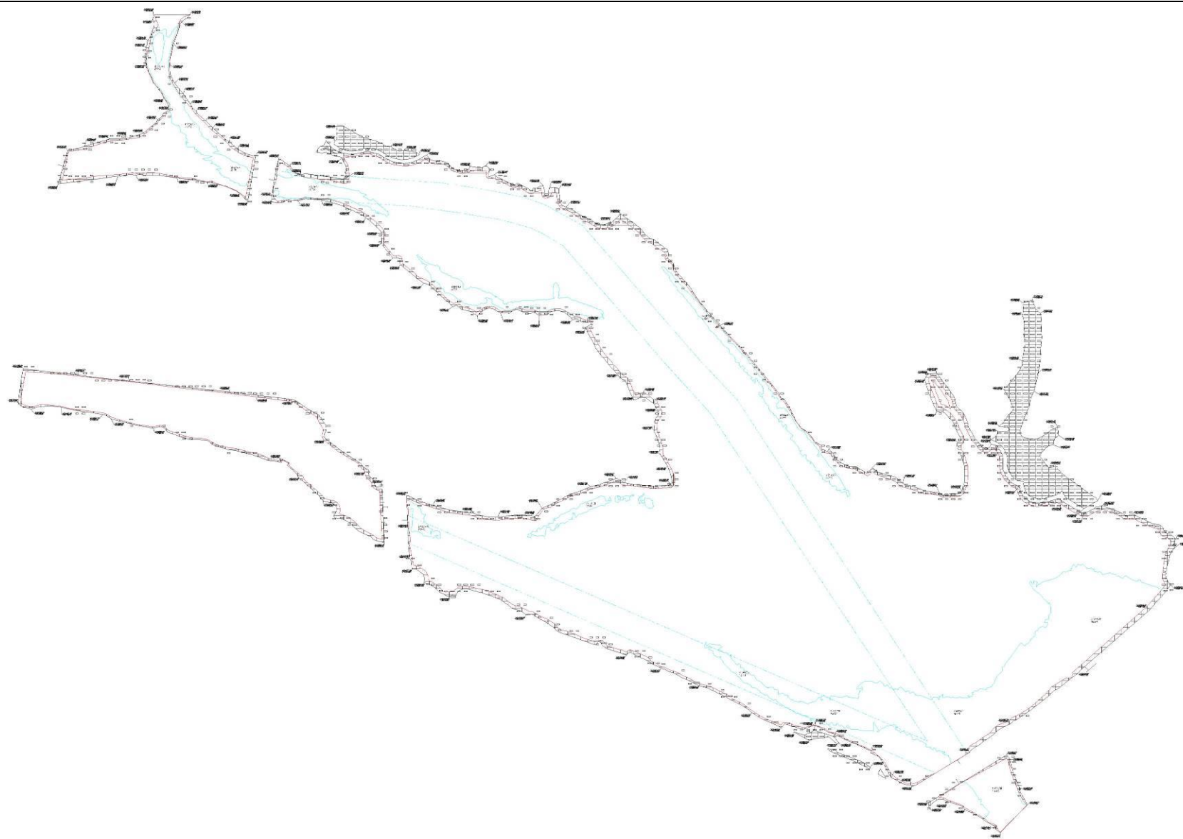
图 3.2-3 移动吸泥泵清淤范围网格图
